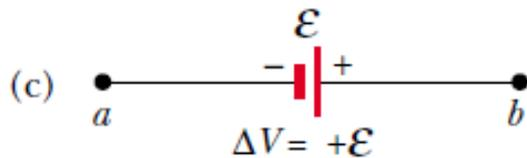
Aquí tenemos una subida de potencial porque la batería esta en la misma dirección que el flujo.
