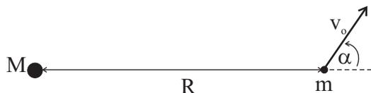
Figura 7.7: Esquema de partícula a distancia  $R$  del centro de fuerza y con velocidad arbitraria.
