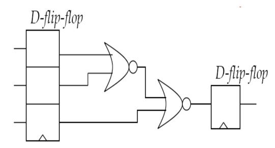
min : typ : max Tclock-Q = 3 : 4 : 5TNOR = 1 : 2 : 3Tsu\_max = 1Thold\_max = 2Tskew = 1 ns
