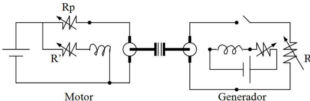
Figura A.1: Esquemático conexión electromecánica
