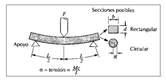
En la figura, se observa como una barra (de cerámico en este caso) es sometido a un ensayo de flexión. El ensayo es conocido como ensayo de "flexo tracción", pues mediante la flexión, se induce de manera directa una tracción en las fibras inferiores de la barra (las que se ubiquen por debajo de la línea neutra).
