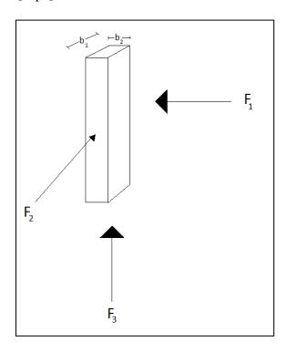
Se pide determinar las deformaciones en el eje vertical (coincidente con  $F_3$ ) considerando el efecto de poisson (Considere v=0.27 y que el material es isotrópico). ¿Cuál sería la diferencia si el material no fuera isotrópico? Justifique su respuesta.
