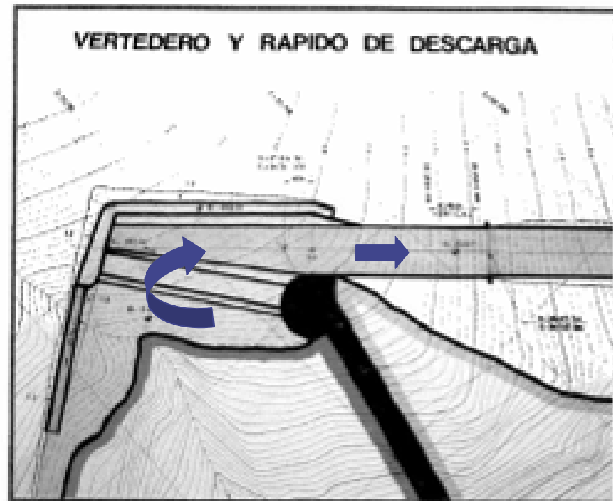
Vertedero y comienzo del rápido de descarga.
