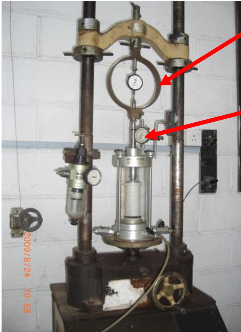
Anillo de carga para medir la carga desviadora
