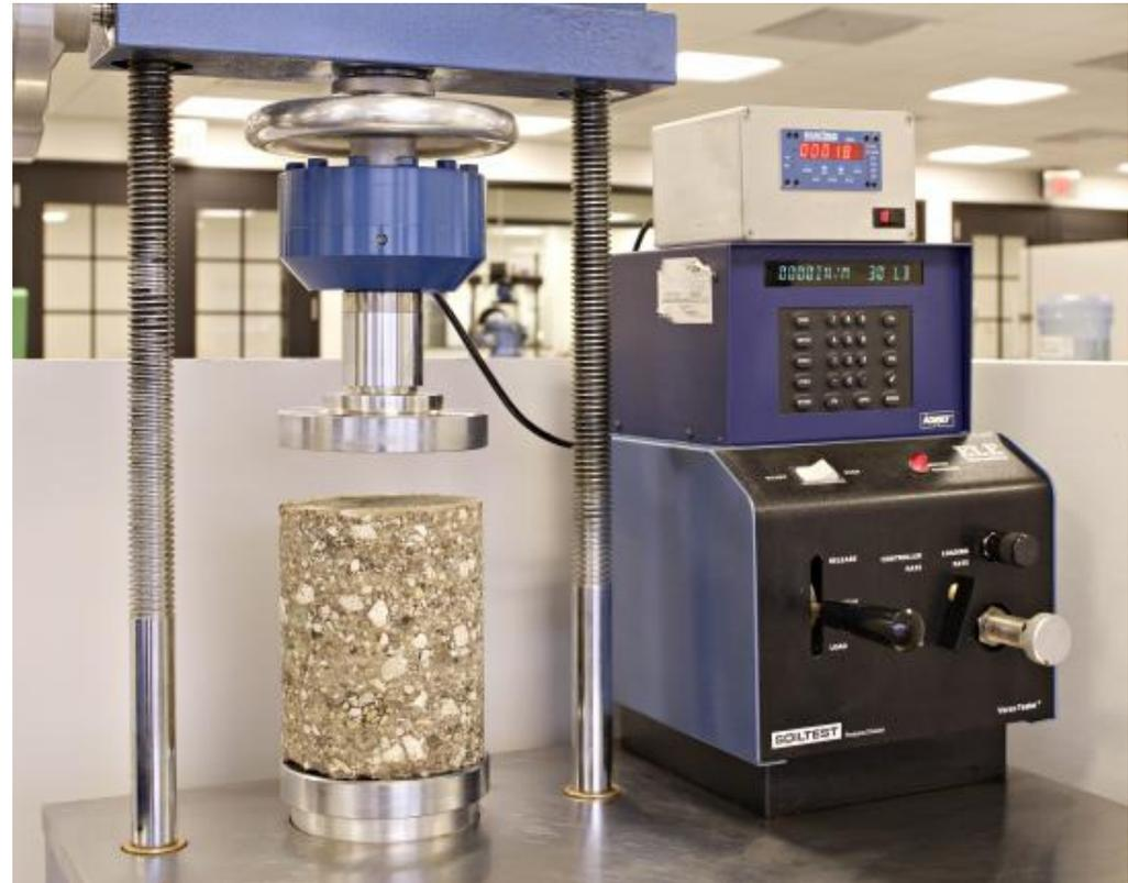
La presión de confinamiento es cero en el ensayo UC
