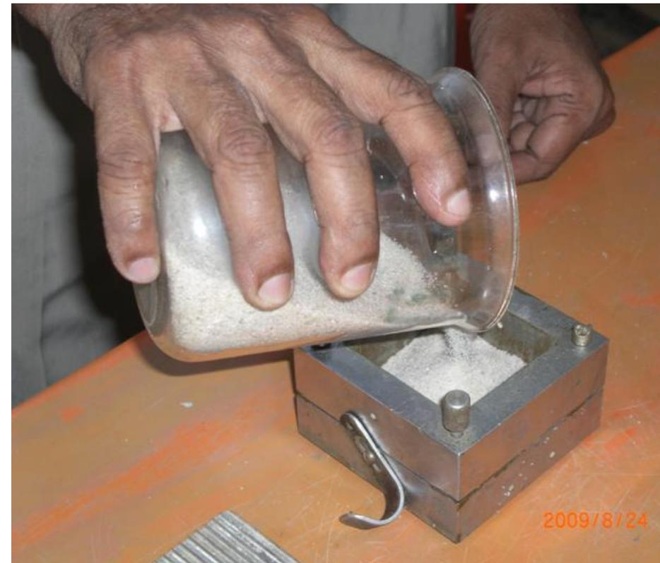
Preparacion de probeta de arena
