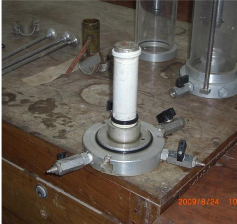
Probeta es cubierta con membrana de latex y sellada
