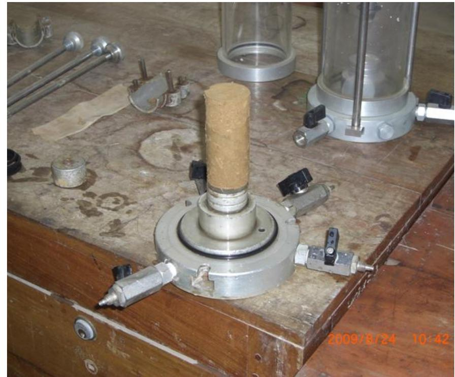
Colocación de la probeta en celda triaxial
