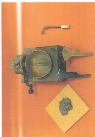
Figura 2.5 Cuchara de Casagrande para determinación del límite líquido. Se observa la arcilla amasada y colocada sobre la cuchara con el canal ya abierto. También pueden verse tres tipos de acanaladores usados en la práctica.
