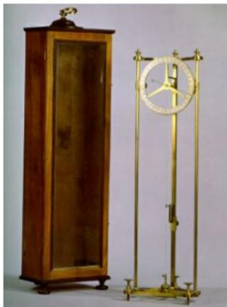
*Figura:* Higrómetro mecánico.
