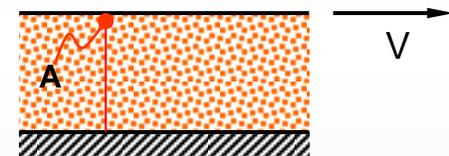
FLUIDO IDEAL: Al no existir adherencia, una partícula de fluido en contacto con la placa que se mueve con velocidad  $V$ , no se desplaza con la placa.
