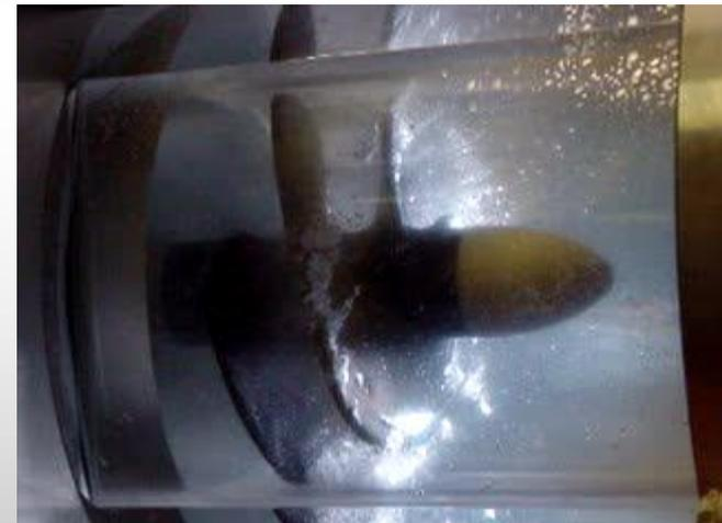
Generación de burbujas de vapor de agua en el extremo de los álabes. Debido a la gran velocidad, la presión disminuye y alcanza el valor de  $p_v$ .
