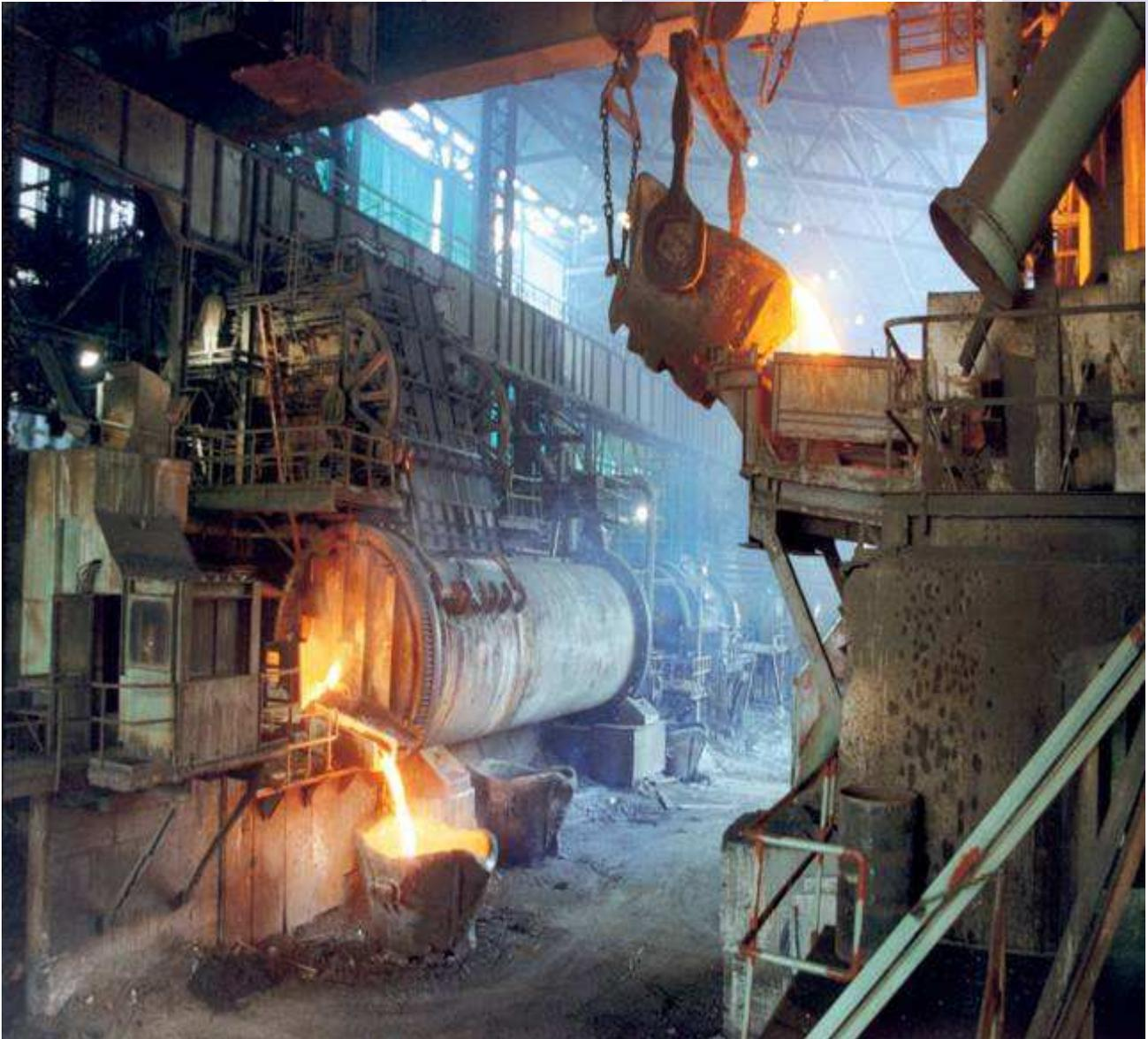
***Figura 7. Convertidor Teniente***
