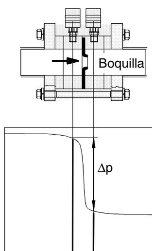
La carcasa del Diafragma/Boquilla es de plexiglás para permitir una observación de la función. El caudal provoca una pérdida de presión entre la entrada y salida, que puede ser leído con los empalmes de medición. La pérdida de presión  $\Delta p$  es una medida para el volumen de salida:
