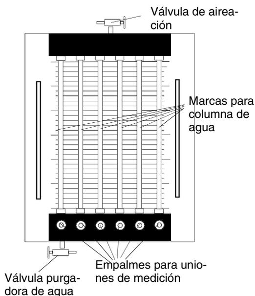
El manómetro multitubos séxtuple posee 6 cilindros de cristal con una escala de mm para la medición de la columna de agua (CA). Aquí se usa a menudo la unidad mmCA. ( $10\text{mmCA} \hat{=} 1\text{mbar}$ )
