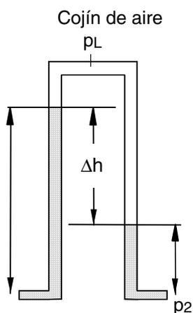
La válvula de aireación está cerrada. Encima de las dos columnas de agua representadas se encuentra un cojín de aire con la presión  $p_L$ .
