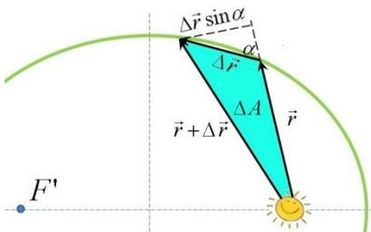
El valor  $\Delta A$  es el área del triángulo formado por los tres vectores de la figura, donde  $\alpha$  es el ángulo que forma  $\vec{r}$  con  $\Delta\vec{r}$ .
