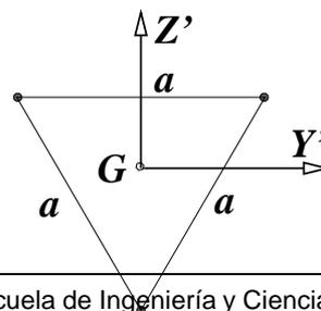
Figura 8.3: Matriz de inercia de un triángulo equilátero de lado  $a$  con respecto a su centro  $G$ .
