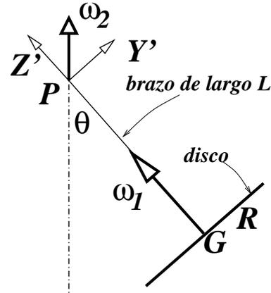
Figura 8.12: Un disco gira en torno a un eje de largo  $L$ . El otro extremo del eje está fijo al punto  $P$ . El sistema  $S'$  tiene eje  $Z'$  que coincide con el brazo de largo  $L$  y el eje  $Y'$  está en el plano de  $Z'$  y la vertical.
