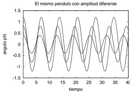
Figura 5.10: El péndulo tiene período diferente para diferentes amplitudes. La figura da  $\phi(t)$  del mismo péndulo lanzado tres veces con velocidad inicial nula desde ángulos iniciales  $\phi(0) = \phi_0$  diferentes.
