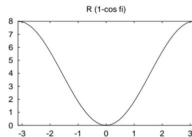
Figura 5.5: La energía potencial asociada al péndulo tiene un mínimo en  $\phi = 0$  y un máximo en  $\phi = \pi$ .
