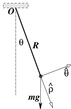
Figura 2.6: Un péndulo consta de un hilo de largo  $R$  fijo en un extremo a un punto  $O$ . En el otro extremo hay una masa puntual  $m$ .
