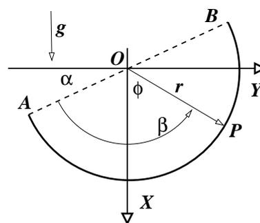
Figura 9.1: Alambre semicircular que oscila debido a su propio peso.
