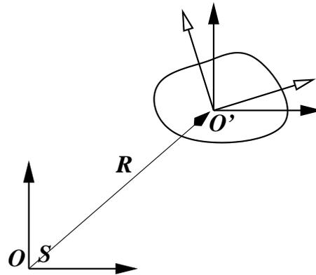
Figura 8.2: Se tiene un sistema inercial  $S$  con origen en  $\mathcal{O}$  y dos sistemas con origen en el punto  $\mathcal{O}'$  fijo al sistema móvil:  $S'$  y  $S''$ . El primero,  $S'$ , tiene ejes que se mueven solidariamente con el sistema extendido mientras que  $S''$  mantiene sus ejes paralelos a los de  $S$ .
