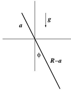
Figura 2.9: . Una barra de largo  $R$  densidad uniforme  $\lambda = M/R$  puede girar en un plano vertical en torno a un punto que divide a la barra en una parte de largo  $a$  y otra de largo  $R - a$ .
