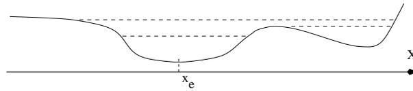
Figura 5.2: Ejemplo de función  $U(x)$  con dos mínimos. Las líneas a trazos representan algunos valores posibles de la energía mecánica total. Puesto que (5.1.1) asegura que esta energía es siempre mayor (a lo sumo igual) a  $U$  entonces para los valores indicados de  $E$  el movimiento no puede extenderse indefinidamente en el eje  $x$ .
