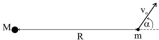
Figura 1.7: Esquema de partícula a distancia  $R$  del centro de fuerza y con velocidad arbitraria.
