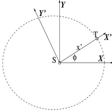
Figura 7.5: Se puede describir el movimiento de un planeta desde dos sistemas de referencias centrados en el Sol. Uno de ellos es inercial y el otro gira de modo que el planeta está siempre sobre el eje  $X'$ .
