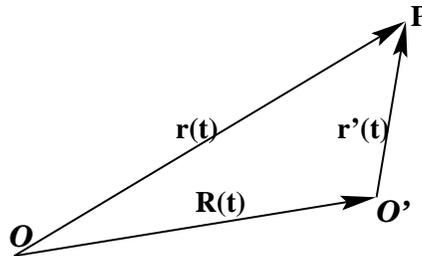
Figura 7.3: El punto móvil  $P$  es visto desde un sistema de referencia  $S$  con origen en  $\mathcal{O}$  y desde un sistema de referencia  $S'$  con origen en  $\mathcal{O}'$  tal que el vector posición  $\vec{R}$  de  $\mathcal{O}'$ . Los ejes de  $S'$  rotan con respecto a  $S$  con velocidad angular  $\vec{\Omega}$ .
