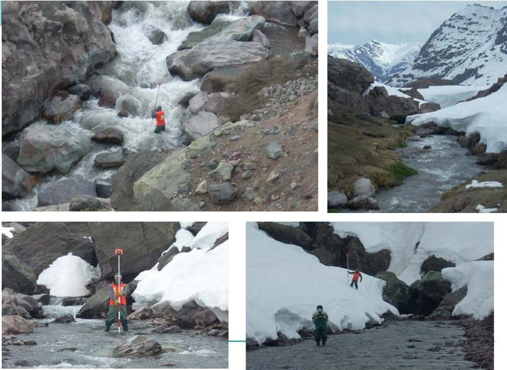
**Figura 7.14:** Levantamiento topobatimétrico secciones del proyecto Alto Maipo. Fuente: [www.seia.cl](http://www.seia.cl)
