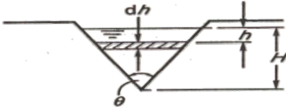
Se considera la descarga a través de una tira angosta de espesor  $dh$  y profundidad  $h$ . El ancho es:
