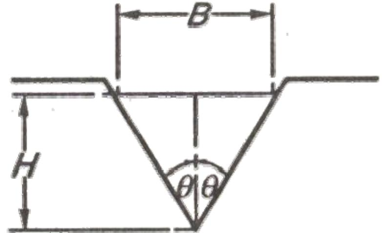
*Se conduce agua por un canal de 1,5 m de ancho con un caudal que varía de 0.006 m<sup>3</sup>/s a 0.7 m<sup>3</sup>/s. si la altura máxima permitida es 125 mm, calcular la profundidad y el ancho de la parte superior de la abertura para el flujo máximo si el coeficiente de descarga es de 0.59. Por otro lado, si el ápice de la abertura se encuentra 1 m arriba del fondo del canal ¿Cuál será el efecto de tomar en cuenta la velocidad de aproximación en el canal en condiciones de flujo máximo?*
