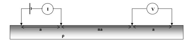
**a)** Determine el factor geométrico k de este arreglo, tal que la resistividad  $\rho$  del subsuelo quede dada por:
