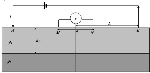
14) En un estudio geoeléctrico de corriente continua para estudiar la resistividad del subsuelo, se usa un arreglo "Dipolo-Dipolo", donde tanto los electrodos de corriente como los de potencial están separados por la misma distancia *a*, y la separación entre ambos pares es *na* (ver figura).
