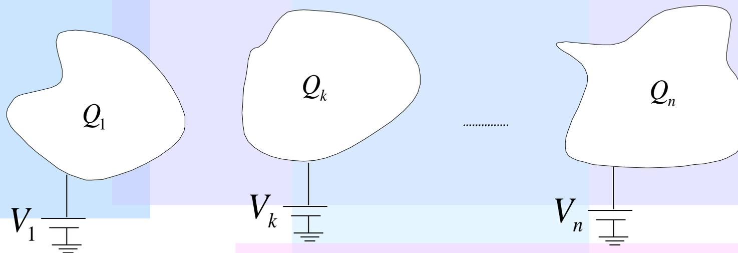
En este caso el potencial en las superficies de los conductores son las condiciones de borde del sistema (además de  $V(\vec{r}) = 0$  para  $\|\vec{r}\| \rightarrow \infty$  )
