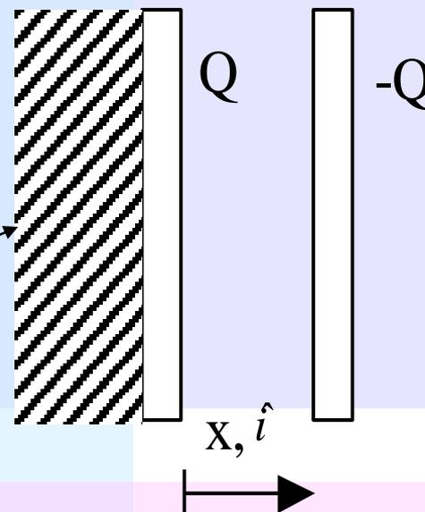
Al producirse el movimiento de atracción, la carga neta se mantiene constante ( $Q = \text{constante}$ )
