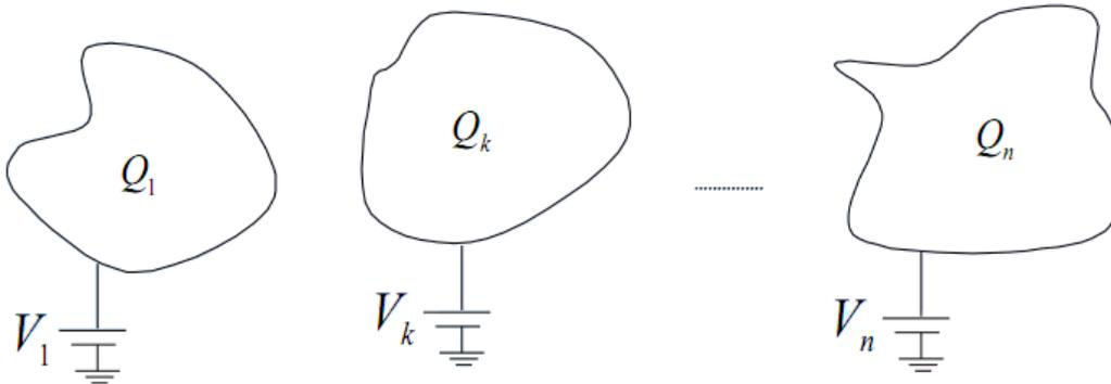
Figura 81. Sistema de conductores en equilibrio electrostático
