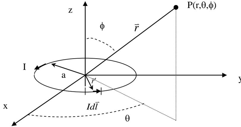
Figura 152. Campo magnético de un dipolo magnético.
