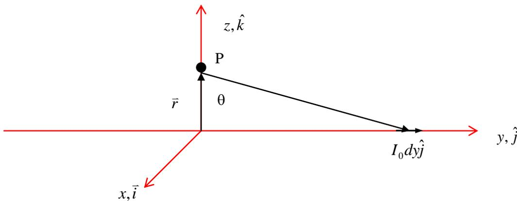
Figura 137. Campo de conductor infinito.
