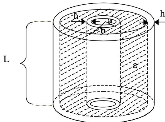
Figura 74. Condensador cilíndrico.
