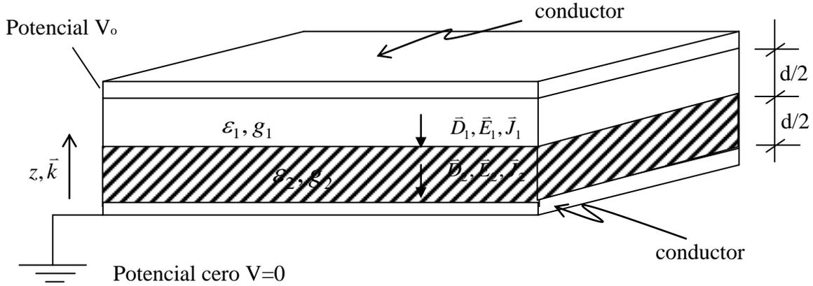
Figura 124. Condensador compuesto sin acumulación de carga.
