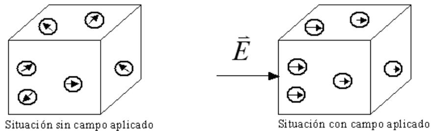
Figura 53. Material lineal, isótropo y no homogéneo.
