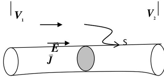
Figura 104. Corriente en conductor irregular.
