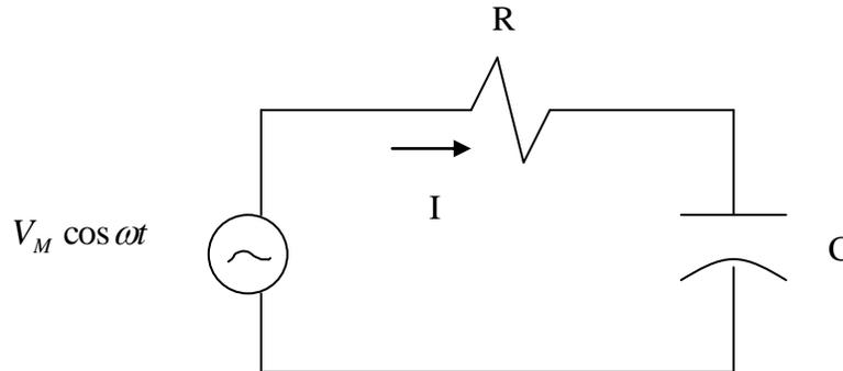
Figura 187. Circuito RC con fuente alterna.
