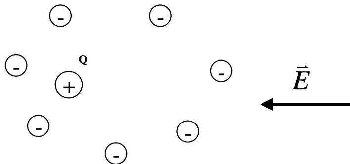
Figura 43. Átomo en presencia de campo eléctrico.
