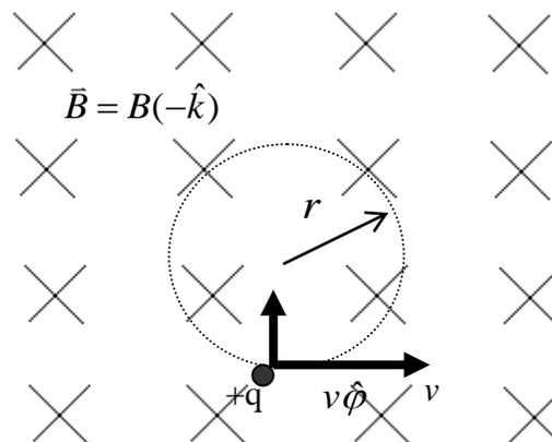
Figura 146. Movimiento de cargas en un campo magnético.
