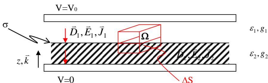
Figura 125. Condensador compuesto con acumulación de carga.
