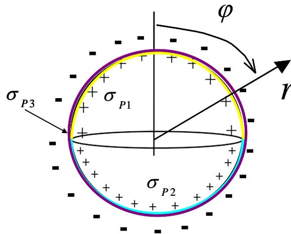
Figura 63. Densidades superficiales de carga de polarización.
