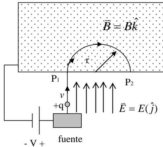
Figura 149. Espectrógrafo de masas.
