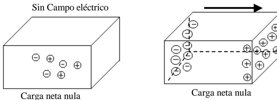
Figura 64. Conductor en presencia de un campo eléctrico.
