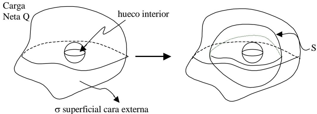
Figura 66. Densidad de carga en conductor hueco.
