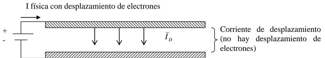
Figura 180. Corriente de desplazamiento en condensador.
