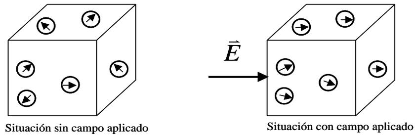
Figura 54. Material lineal, anisótropo y no homogéneo.
