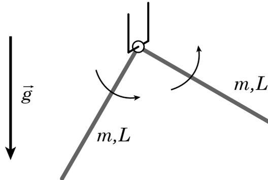
**Indicación:** considere la matriz de inercia de una barra delgada de masa  $m$  y largo  $L$  en un sistema con centro en un extremo de la barra y con uno de los ejes solidario a ella:
