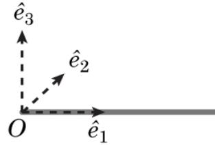
Es natural que  $I_{11} = 0$ : la barra no opone resistencia al girarla en torno al eje  $\hat{e}_1$  (o sea, su eje de simetría), ya que tiene grosor despreciable y las partículas que componen la barra están todas “muy cerca” del eje.
