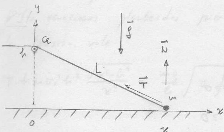
P1/ Planteamos el sistema de referencia. El origen se sitúa en el suelo justo bajo la polea. El eje  $x$  es horizontal,  $\rightarrow$  la masa se desplaza a lo largo del eje  $x$ . El eje  $y$  es vertical.
