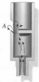
**Figura 16.17** Tubo de órgano de lengüeta. Se sopla una corriente de aire contra el borde originando un movimiento turbulento del aire cerca de A que excita ondas estacionarias en el tubo. Existe un nodo de presión cerca del punto A, que está abierto a la atmósfera.
