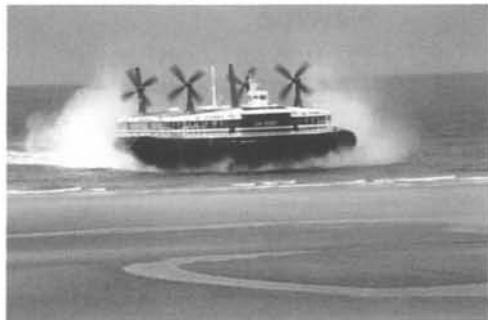
El rozamiento se reduce grandemente mediante un colchón de aire que soporta el aerodeslizador.
