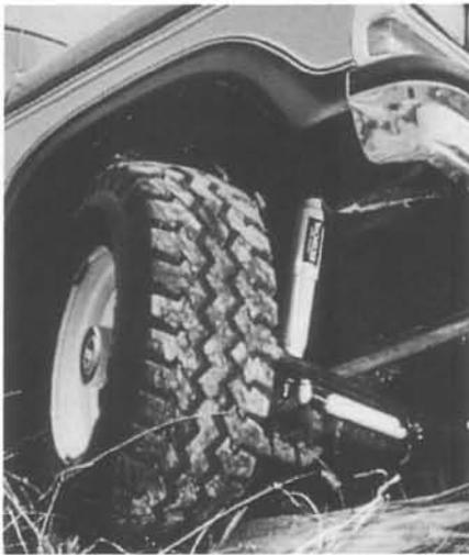
Para amortiguar la oscilación de esta camioneta se utilizan los amortiguadores (cilindros amarillos) que absorben los choques.
