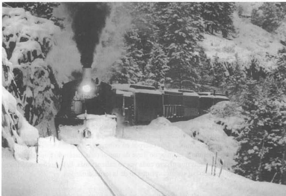
La máquina de este viejo tren produce vapor, el cual hace un trabajo sobre un pistón que obliga a las ruedas del tren a desplazarse. El rendimiento de la máquina de vapor está limitado por el segundo principio de la termodinámica.
