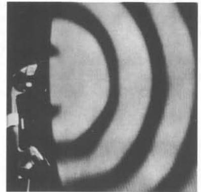
Ondas sonoras procedentes de un receptor telefónico propagándose en el aire. Las ondas se han hecho visibles barriendo el espacio delante del receptor con una lámpara que tiene un brillo controlado mediante un micrófono.
