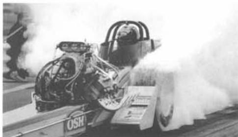
Con el fin de extraer calor del motor y reducir su temperatura, el "dragster" de la figura dispone de un sistema de escape múltiple.
