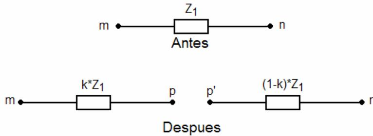
**Figura 2: Fraccionamiento de una línea.**
