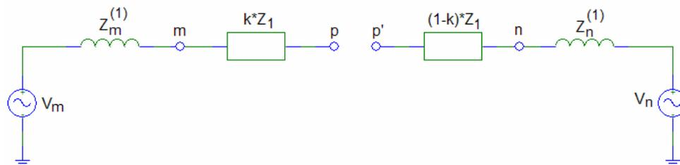
**Figura 3: Secuencia positiva de una línea con una fase cortada.**
