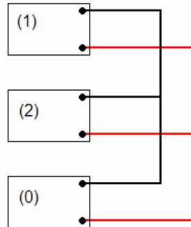
**Figura 4: Conexión paralela de las secuencias de la fase "a".**
