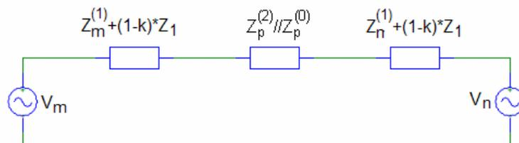
**Figura 6: Circuito simplificado de la modelación del SEP.**
