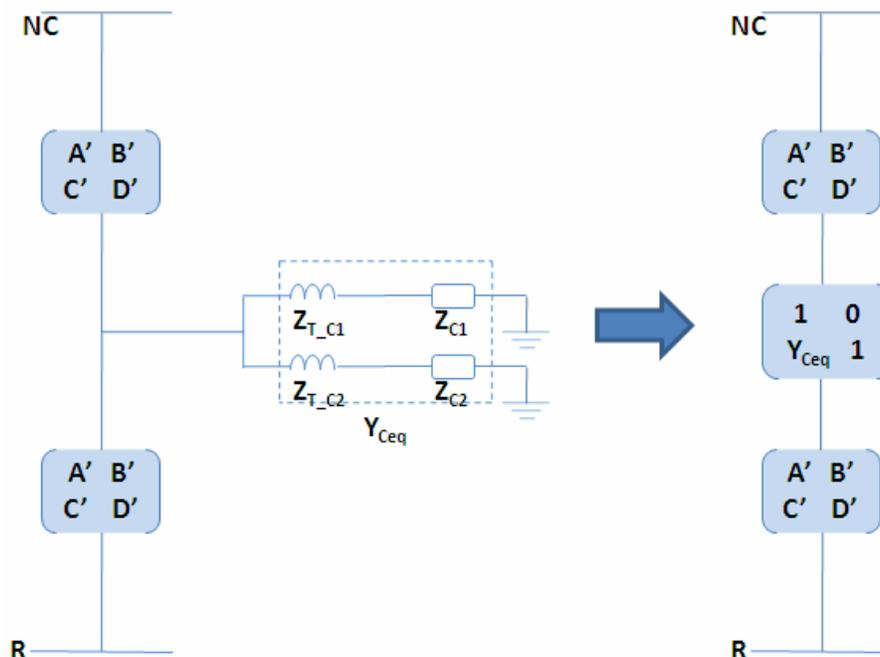
La conexión en tap-off desde Carrascal al cable Renca- Nodo Común ocurre en la mitad del cable, es por ello que las nuevas matrices  $A'B'C'D'$  resultantes son iguales y se calculan a partir de la mitad de la impedancia  $Z_L$  y la mitad de la admitancia  $Y_L/2$  del modelo pi original (de la pregunta 2) . Esto es:
