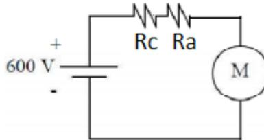
Figura 1: modelo del motor serie
