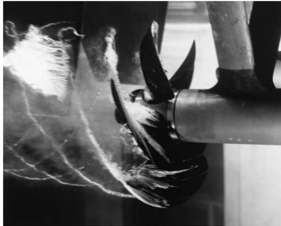
**Figura 2.10:** Formación de estela de gases atrás de una hélice.
