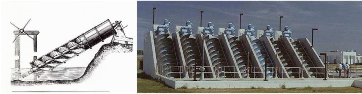
**Figura 1.7:** Tornillo de Arquímedes. La imagen de la derecha corresponde al sistema de utilizado en una planta de tratamiento de agua en Memphis. La planta de tratamiento de La Farfana emplea un sistema similar, pero se encuentra cubierto, por lo que no se aprecia el tornillo sin fin.
