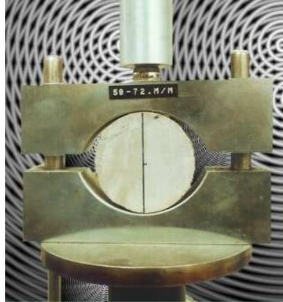
Fig 4.2. Equipo utilizado en el ensayo de tracción directa.
