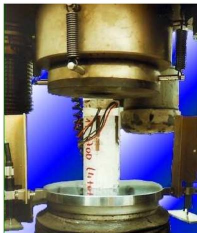
Fig 2.1. Equipo utilizado en el ensayo de compresión uniaxial
