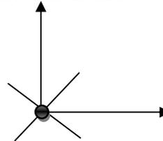
El único punto del poliedro  $(0,0)$  es una solución básica factible degenerada, ya que tiene 2 variables y 2 restricciones y, por lo tanto, debería tener  $(n - m) = 0$  componentes nulas para no ser degenerada, lo cual no se cumple y además tiene una sola base asociada  $B = \{1,2\}$ .
