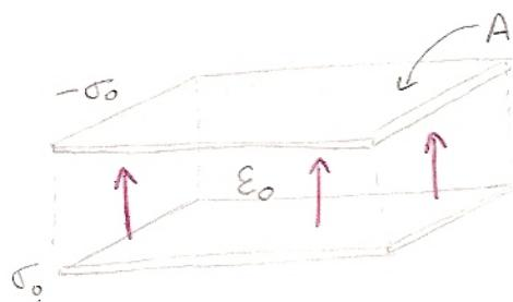
Campo producido por una placa conductora infinita (o despreciando efectos de borde).
