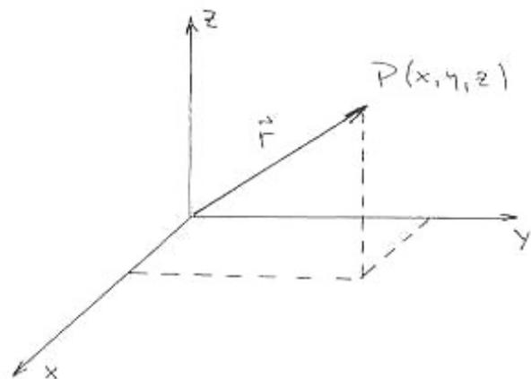
Al expresar el movimiento en coordenadas cartesianas se obtienen componentes independientes para la posición, velocidad y aceleración según cada uno de los ejes tri-ortogonales. De este modo, estas componentes pueden ser analizadas en forma independiente, con sus correspondientes condiciones de borde.
