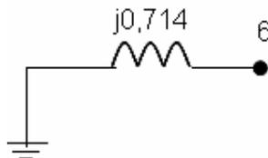
**Ilustración 8: Equivalente de secuencia cero visto desde la barra 6**
