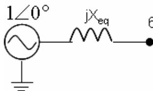
**Ilustración 2: Equivalente del sistema visto desde barra 6**
