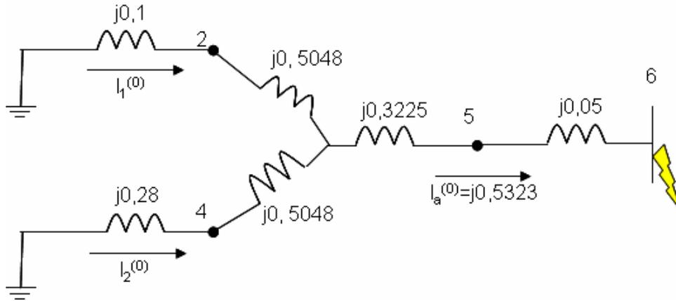
**Ilustración 11: Malla de secuencia cero con equivalente estrella-delta**
