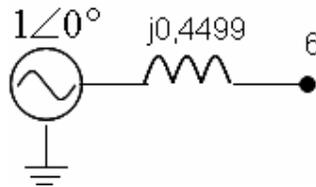
**Ilustración 4: Equivalente de secuencia positiva visto desde barra 6**
