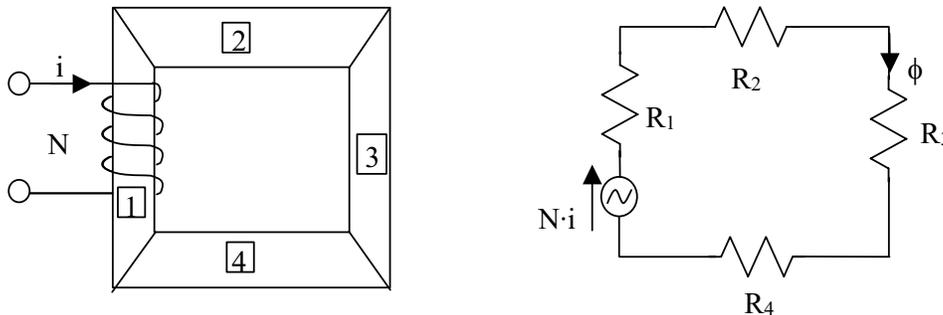
Figura 2.8. Circuito magnético y su equivalente eléctrico
