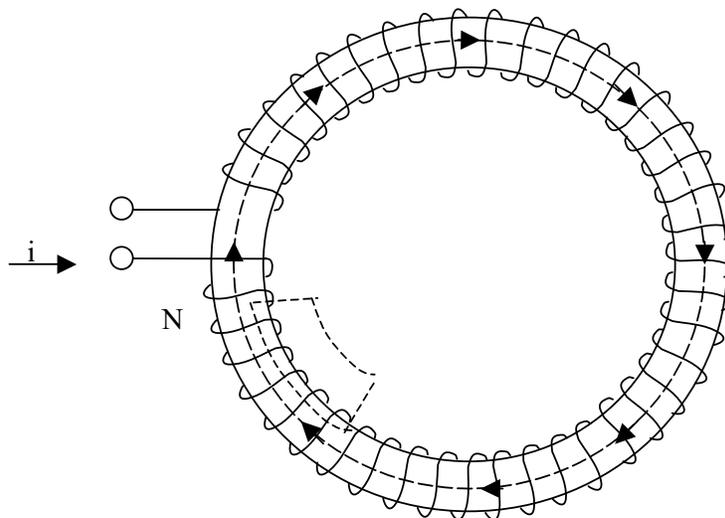
Figura 2.7. Circuito magnético simple
