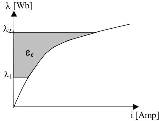
Figura 2.12. Energía en campo magnético
