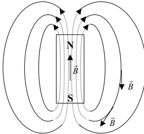
Figura 2.1. Campo magnético de imán permanente.
