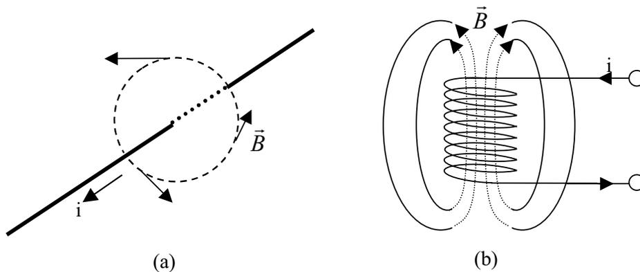
Figura 2.2. Campos magnéticos creado por corriente eléctrica
