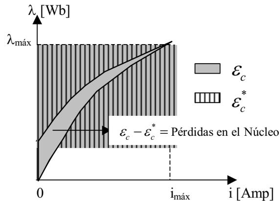
Figura 2.14. Energía perdida en el núcleo
