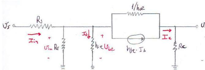
Para calcular la resistencia de entrada, hacemos la corriente de salida  $I_o = 0$ , esto implica  $R_L = \infty$ . Luego se tiene
