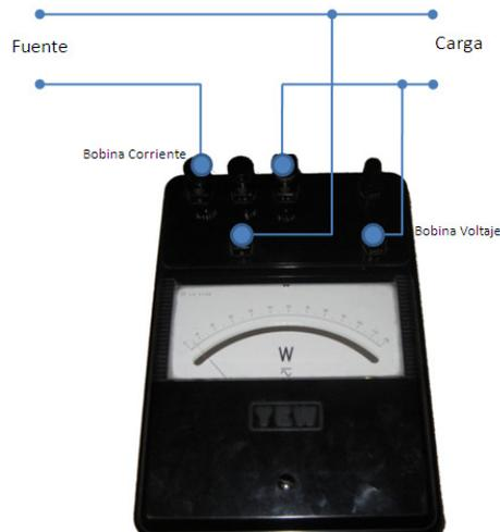
Figura 2.2.5 - Conexión de un wáttmetro.
