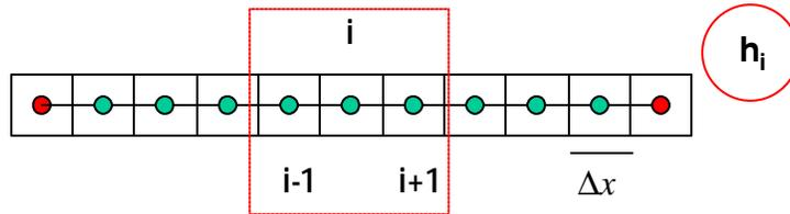
$$\left. \frac{\partial h}{\partial x} \right|_i \left\{ \begin{array}{l} \frac{\partial h}{\partial x} \Big|_i \cong \frac{h_{i+1} - h_i}{\Delta x} \quad \text{Aproximación hacia adelante} \\ \frac{\partial h}{\partial x} \Big|_i \cong \frac{h_i - h_{i-1}}{\Delta x} \quad \text{Aproximación hacia atrás} \\ \frac{\partial h}{\partial x} \Big|_i \cong \frac{h_{i+1} - h_{i-1}}{2 \cdot \Delta x} \quad \text{Aproximación central} \end{array} \right.$$
