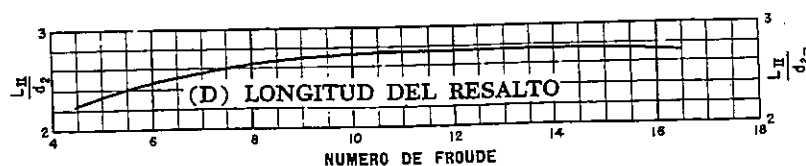
FIG. 206. Características de los estanques amortiguadores para números de Froude mayores de 4.5, cuando las velocidades de llegada no exceden de 50 pies/seg
