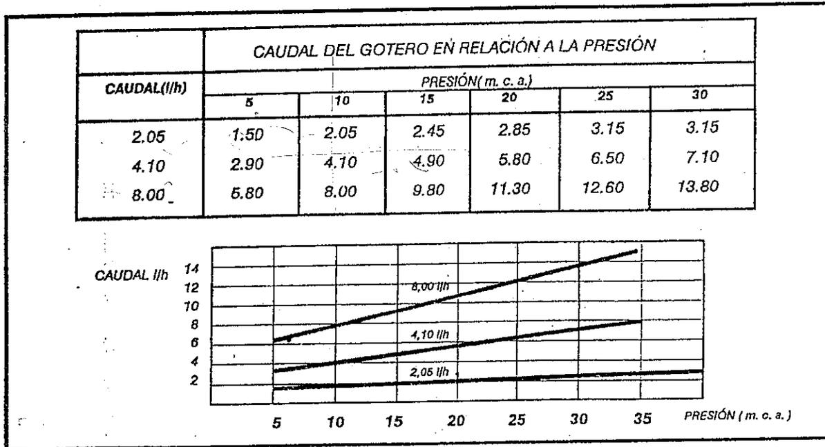
Figura 5: Relación caudal versus presión para goteros de 2,4 y 8 litros por hora.
