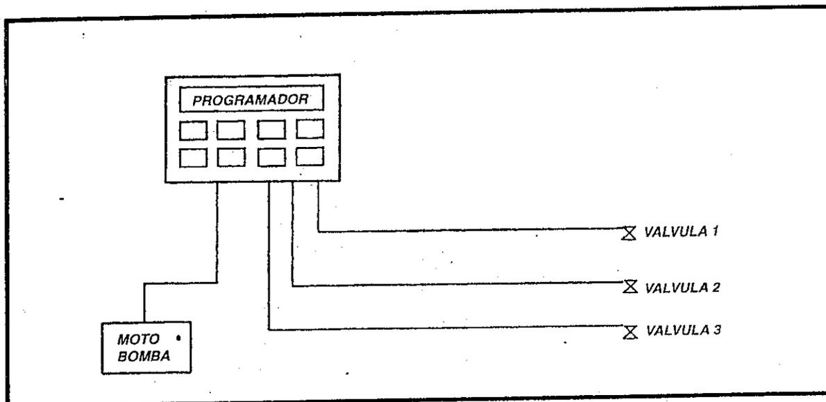
Figura 8: Componentes de un sistema de automatización
