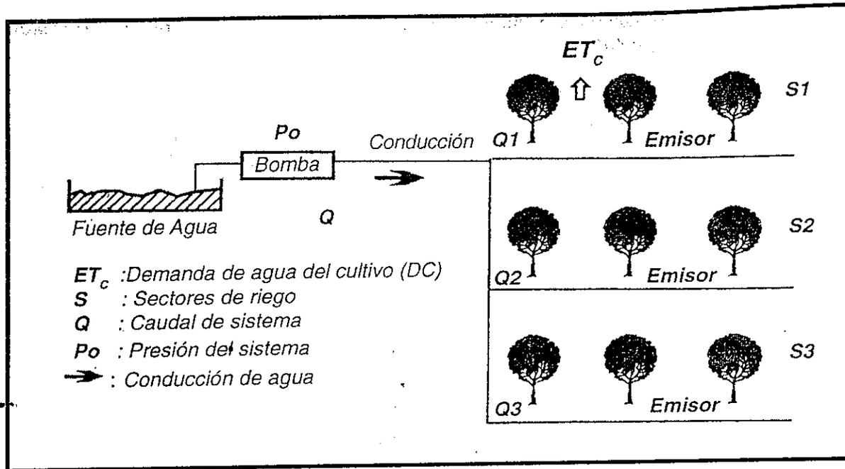
**Figura 3:** Esquematación de los criterios a considerar en el diseño de un riego presurizado.
