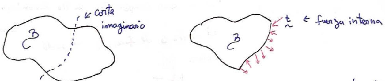
$\tilde{t}$  depende la posición, pues la fuerza interna o la de superficie cambia en magnitud punto a punto (en la configuración actual). ①
