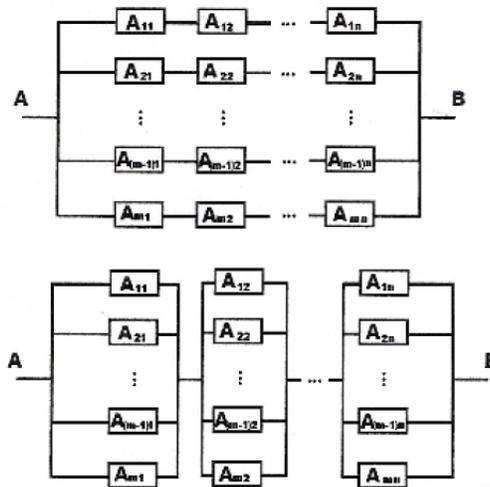
Las componentes  $A_{ij}$  tienen una probabilidad  $p$  de funcionar ( $(1-p)$  de fallar) y lo hacen de forma independiente. Calcule para ambos circuitos la probabilidad que exista flujo desde el punto  $A$  hasta el punto  $B$ .
