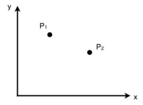
En tal sistema podemos asignar las coordenadas  $(x_1, y_1)$  para caracterizar la posición del primer punto y  $(x_2, y_2)$  para la posición del segundo. Más aun, apoyados de la noción de
