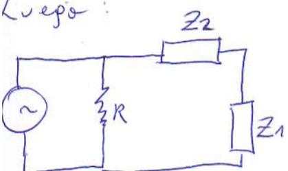
$$Z_2 = \frac{1}{j\omega C} // 2R \xrightarrow{\text{"suma en paralelo"}} \left( \frac{1}{j\omega C} + \frac{1}{2R} \right)^{-1} = \frac{2R}{j\omega C} \cdot \frac{1}{\frac{1}{j\omega C} + 2R} = \frac{2R}{1 + j\omega 2RC}$$
