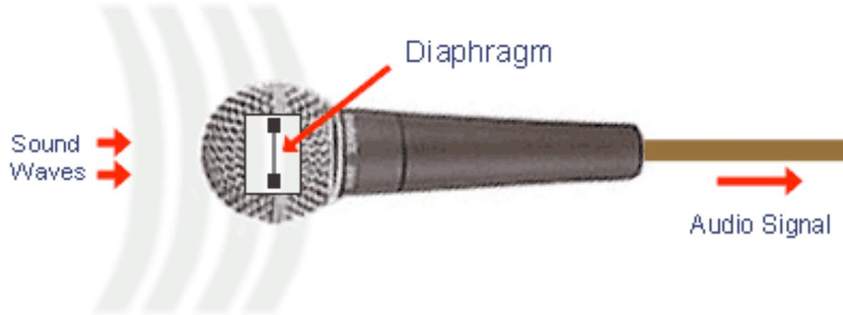
El diafragma se mueve en presencia de una onda acústica y a su vez es parte de un condensador.
