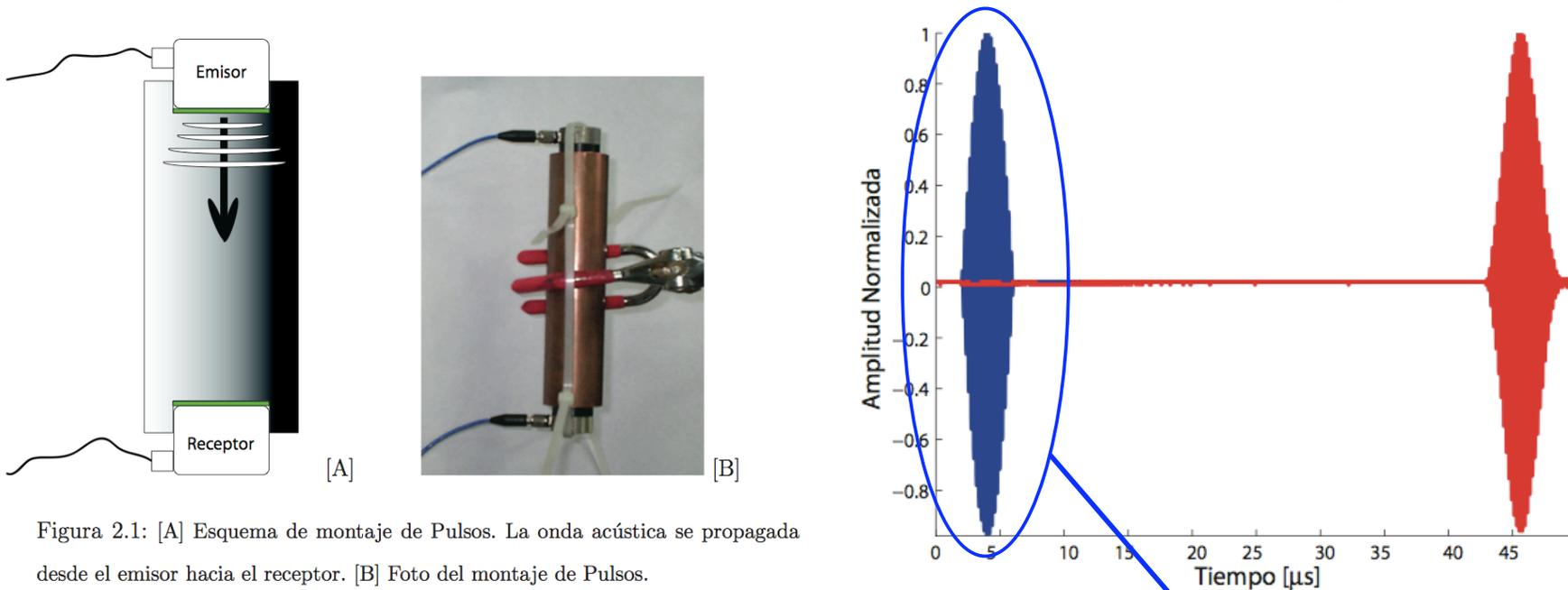
Figura 2.1: [A] Esquema de montaje de Pulsos. La onda acústica se propagada desde el emisor hacia el receptor. [B] Foto del montaje de Pulsos.
