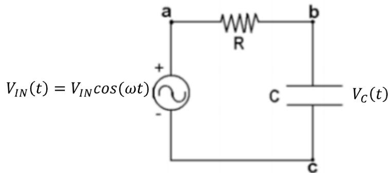
Para una entrada cualquiera, la ecuación diferencial que define el voltaje sobre el condensador en función del tiempo es:
