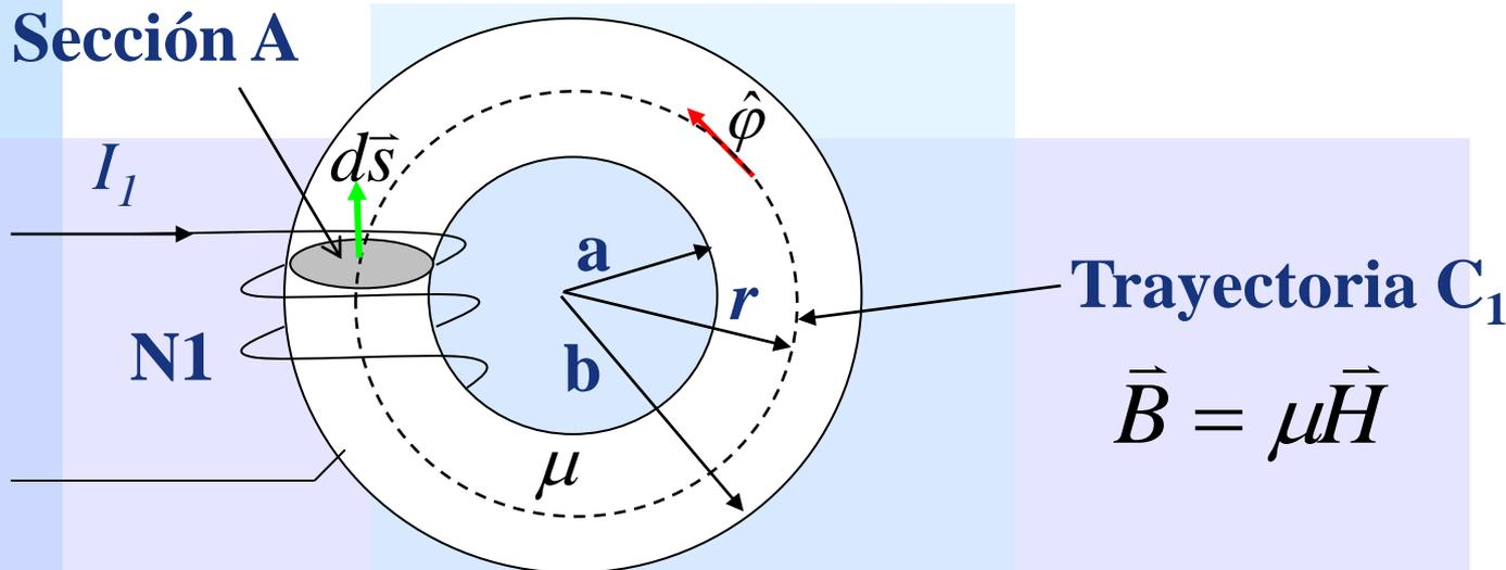
Flujo enlazado por una vuelta  $\phi = \iint_A \vec{B} \cdot d\vec{s}$
