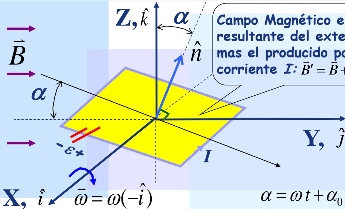
Campo Magnético es el resultante del externo mas el producido por la corriente  $I$ :  $\vec{B}' = \vec{B} + \vec{B}_I$
