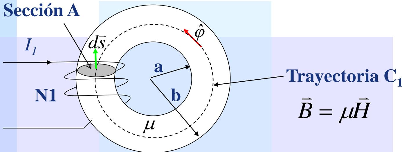
**Flujo enlazado por todo el circuito**  $\phi_T = N_1 \frac{\mu N_1 I_1 A}{\pi(a+b)}$
