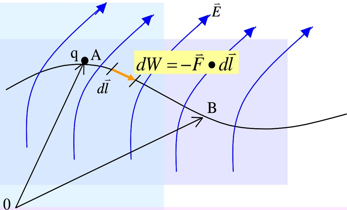
$$V_{BA} = \frac{1}{q} \int_A^B (-q\vec{E}) \cdot d\vec{l} \Rightarrow V_{BA} = - \int_A^B \vec{E} \cdot d\vec{l}$$
