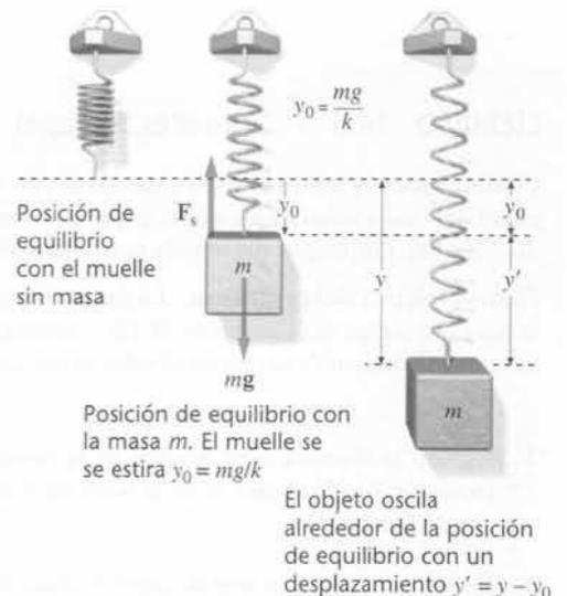
Figura 14.11 El problema de una masa colgada de un muelle vertical se simplifica si el desplazamiento ( $y'$ ) se mide desde la posición de equilibrio del muelle conectado a la masa.
