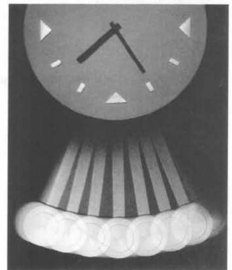
Todos los relojes mecánicos mantienen la hora exacta porque el periodo del elemento oscilante del mecanismo permanece constante. El periodo de cualquier péndulo cambia con las variaciones de la amplitud, pero el mecanismo que mueve un reloj de péndulo mantiene la amplitud a un valor constante.
