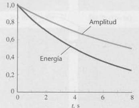
Figura 14.22 Representación de  $A/A_0$  y de  $E/E_0$  para una cuerda de piano pulsada.
