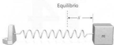
**Figura 14.1** Cuerpo unido a un muelle que descansa sobre una mesa sin rozamiento. Se mide el desplazamiento  $x$  desde la posición de equilibrio. El desplazamiento es positivo si el muelle se estira y negativo si el muelle se comprime.
