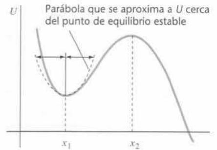
Figura 14.9 Gráfico de  $U$  en función de  $x$  para una fuerza que tiene una posición de equilibrio estable ( $x_1$ ) y otra de equilibrio inestable ( $x_2$ ).
