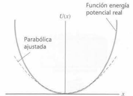
Figura 14.10 Dibujo de  $U$  respecto a  $x$  para una partícula pequeña que oscila en el fondo de un cuenco con forma esférica.
