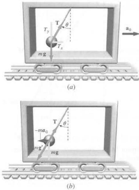
**Figura 14.15** (a) Péndulo simple en equilibrio aparente en un furgón con movimiento acelerado. Las fuerzas que se muestran corresponden a un sistema estacionario exterior. (b) Fuerzas que actúan sobre la lenteja observadas en el sistema acelerado. Sumar la pseudofuerza  $-ma_0$  es equivalente a reemplazar  $g$  por  $g'$ .
