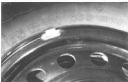
En las llantas de las ruedas de los coches se colocan pesos para equilibrarlas. El objetivo de equilibrar las ruedas es evitar las vibraciones que producirían las oscilaciones de la dirección del vehículo.
