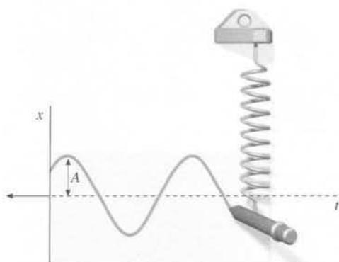
**Figura 14.2** Una plumilla está sujeta a la masa de un muelle y el papel se mueve hacia la izquierda. Cuando el papel se mueve con velocidad constante, la plumilla va dibujando el desplazamiento  $x$  en función del tiempo  $t$ . (En este caso hemos considerado  $x$  como positivo cuando el muelle se comprime.)
